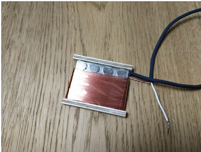
Alpen 4-String Single Coil mit hochpermeablem Nickel Kern
